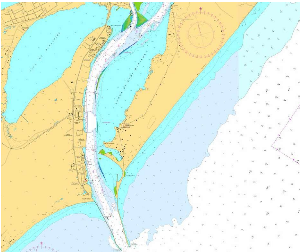
Figura 8: Batimetria com filtro de visualização de profundidades de 0 à -6,5 metros.
