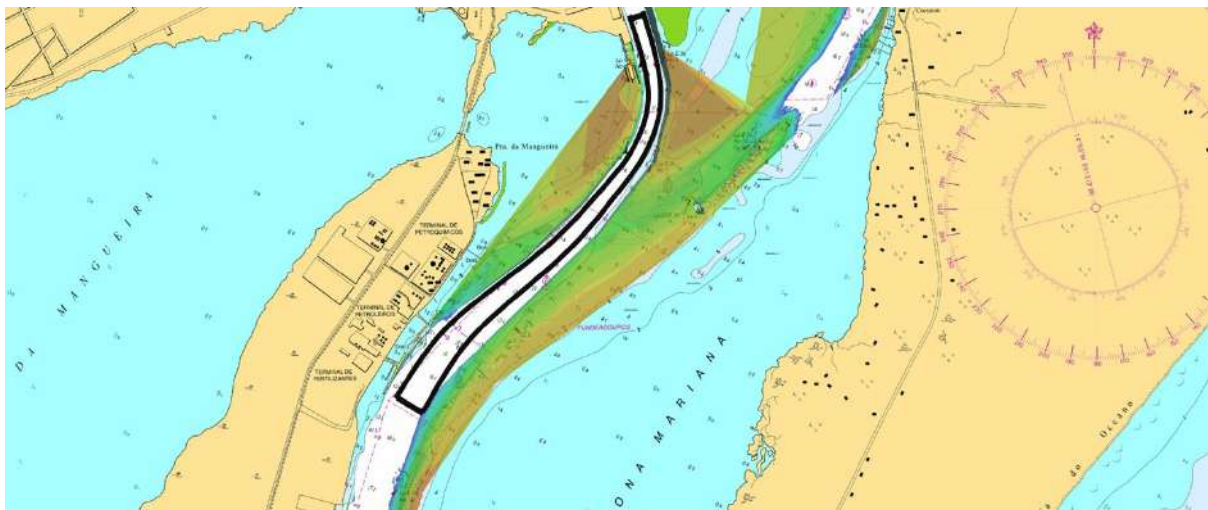
Figura 208: Indicação de região sugerida de acompanhamento de rebocadores em condição de vazante crítica.
