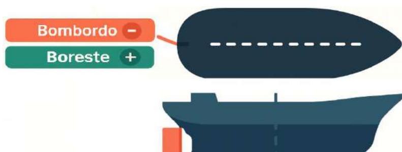
Figura 22: Convenção de sinais adotados para a posição do leme/azimute
